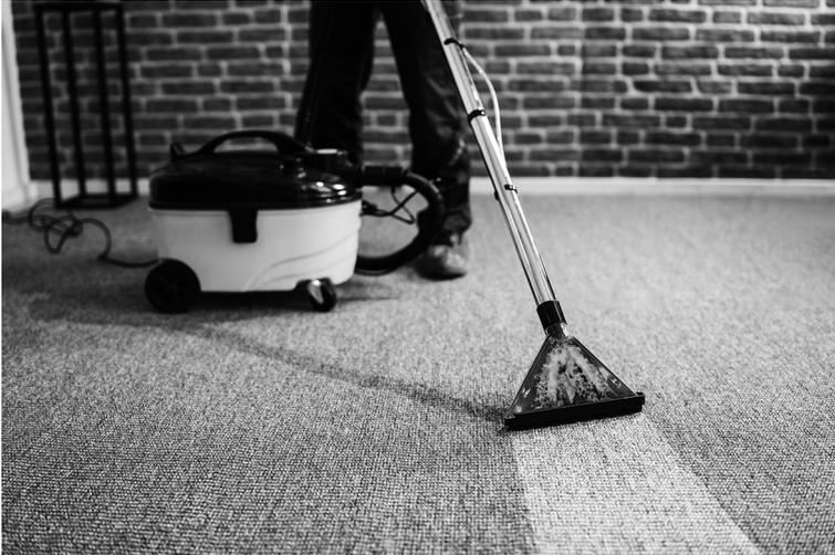
In de stoomreiniger zit een afgesloten vat dat gevuld is met water en lucht. Het vat wordt verwarmd met een verwarmingselement op netspanning. Als de temperatuur in het vat stijgt, neemt de druk in het vat toe.
